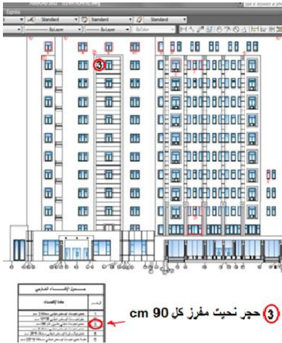
الشكل (4-7) إكساء الواجهات حجر بوشاردة (واجهة AutoCAD) الشكل (4-8) إكساء الواجهات حجر نحيث مفرز (واجهة AutoCAD)
